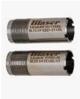
Moderne Wechsel-Chokes sind meist eindeutig gekennzeichnet. Will man Weicheisen, Kupfer o. Tungsten verschießen, darf man nur geeignete Chokes einschrauben.
